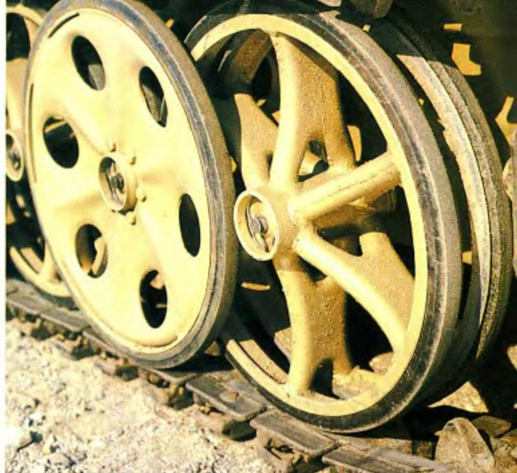
Anbild der verschiedenen Rader des Kettenkrafz
